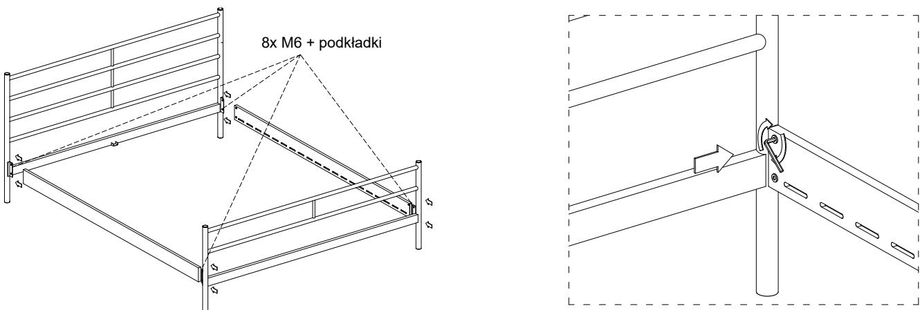
(PL) Po założeniu boków na blachy w wezgłowiąch, mocno dokręcić śruby (CZ) Po nasazení bočnic na plechy v čelech pevně utáhněte šrouby (SK) Po nasadení bočník na plechy v čelách pevně dotiahnite skrutky (DE) Nach dem Einsetzen der Seitenteile in die Bleche an den Kopfenden die Schrauben fest anziehen (EN) After attaching the side panels to the plates on the headboards, tighten the screws firmly.
