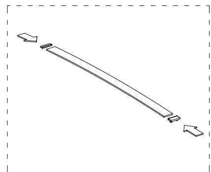
(PL) Wcisnąć listewki z kieszonką w otwory w bokach łóżka (CZ) Zatlačte lamely s kapsami do otvorů na bocích posteče (SK) Zasuňte lamely s kapsičkami do otvorov na bokoch posteče (DE) Drücken Sie die Latten mit den Halterungen in die Löcher an den Seiten des Bettes (EN) Push the slats with the holders into the holes on the bed sides.
